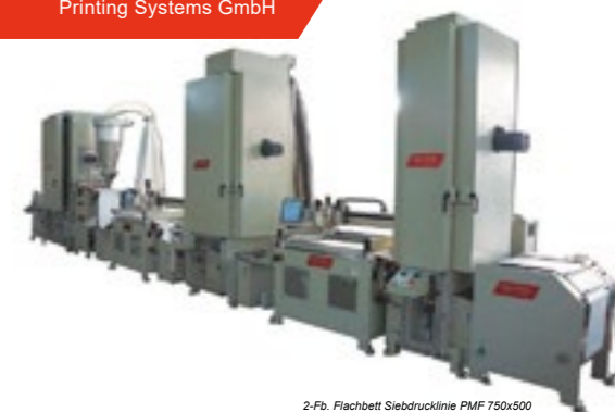
2-Fb. Flachbett Siebdrucklinie PMF 750x500
