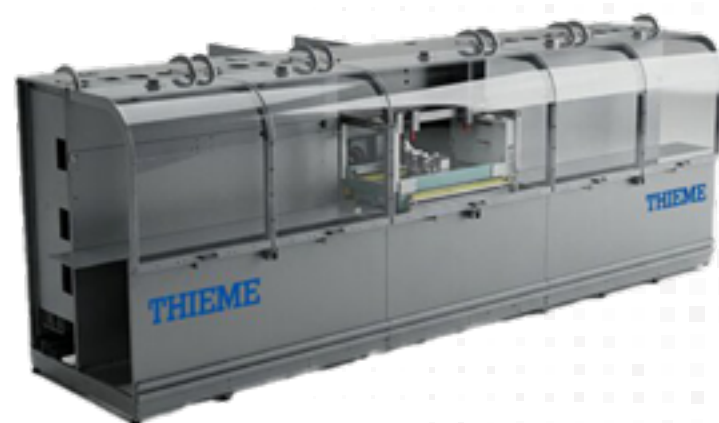
THIEME erweitert sein Portfolio im industriellen Siebdruck um die neue Flachbett-Rolle-zu-Rolle-Linie THIEME 6000 PE für funktionale Schichten, insbesondere in der gedruckten Elektronik.
